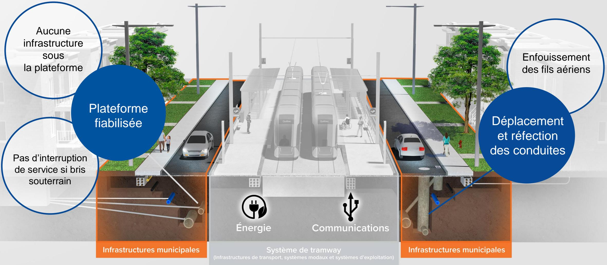
Exemple d'une insertion axiale (au centre de la chaussée) du tramway en station
